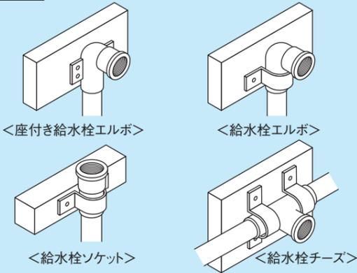
**破損** 荷重 固定しないと荷重により管、継手が破損し、漏水することがあります。
