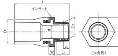
インサートの材質はJIS H 5121 (銅合金連続 铸造物)のCAC406Cです。
