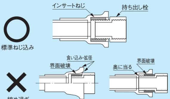
ねじの短い持ち出し栓の場合、継手のねじ受口に食い込み、拡張し、金属インサートと塩ビの界面が破壊されて漏水することがあります。
