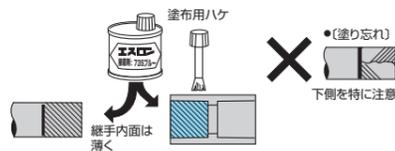
●管・継手種類に合った専用の接着剤を薄く全体的に、継手の内面、管の外側の順に塗布します。
